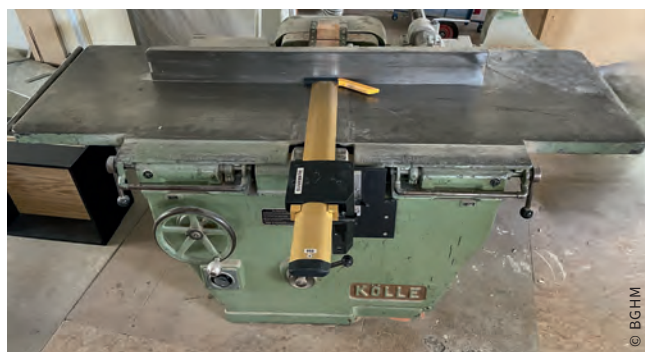
Zwei mit Brückenschutz umgerüstete Altmaschinen
